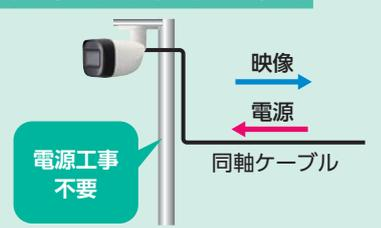
フルハイビジョンなどの高画質で撮影した映像を、既存のアナログカメラの同軸ケーブル配線をそのまま利用して伝送、録画ができるのが、『同軸カメラシステム』ですが、さらにその同軸ケーブルでカメラへの電源供給もできるのが、『ワンケーブルカメラシステム』です。
