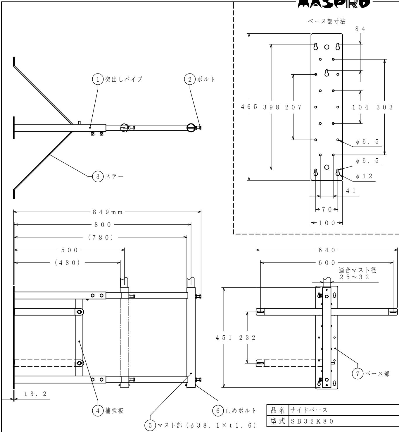
寸法は、マスト径 32 mm、突出しパイプを最大限伸ばした場合を示す。
