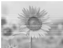
携帯電話の電波で受信障害を受けている画面
